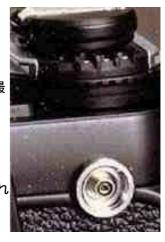
メラがスタジオで使われることが多かったことからプロサービス部門で慌ててペンタプリズム部に穴を開けてこれを装着するということも起こった。外れ防止ネジというのはこの根本にネジを切ってあるもので、それに対応した専用のシンクロコードを使えば抜ける心配なしに使う事ができる。
